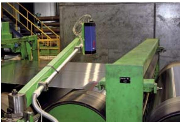
Abb. 8: Installation ASCOSpeed Reckanlage einlaufseitig ...
