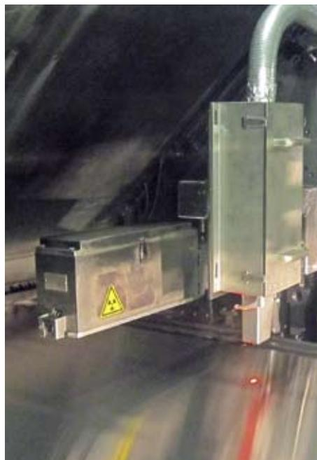
Abb. 3: Installation im Walzwerk mit Luftversorgung (Schlauch)
