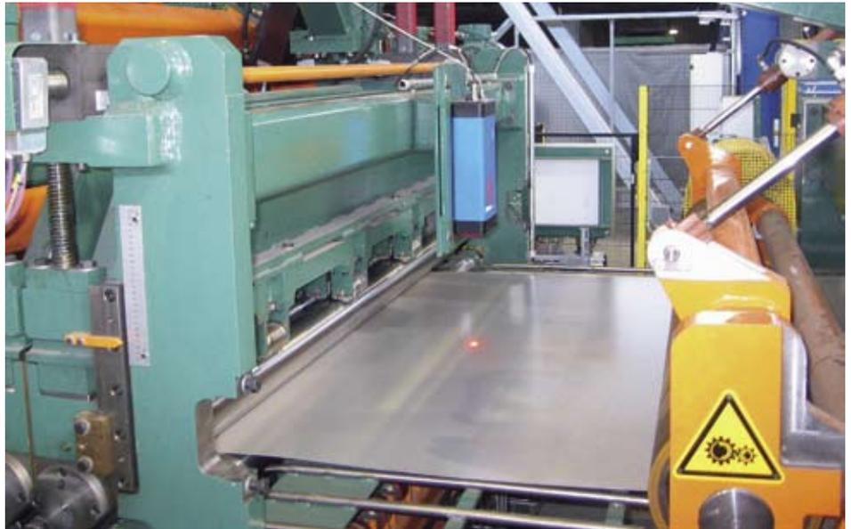
Abb. 6: ASCOSpeed in einer Schneidanlage für Automotive-Produkte
