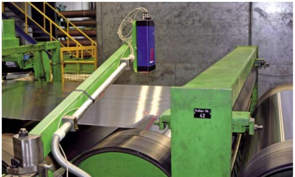
Abb. 7: Synchronisierter Betrieb in einer Reckanlage zur Streckgradmessung
