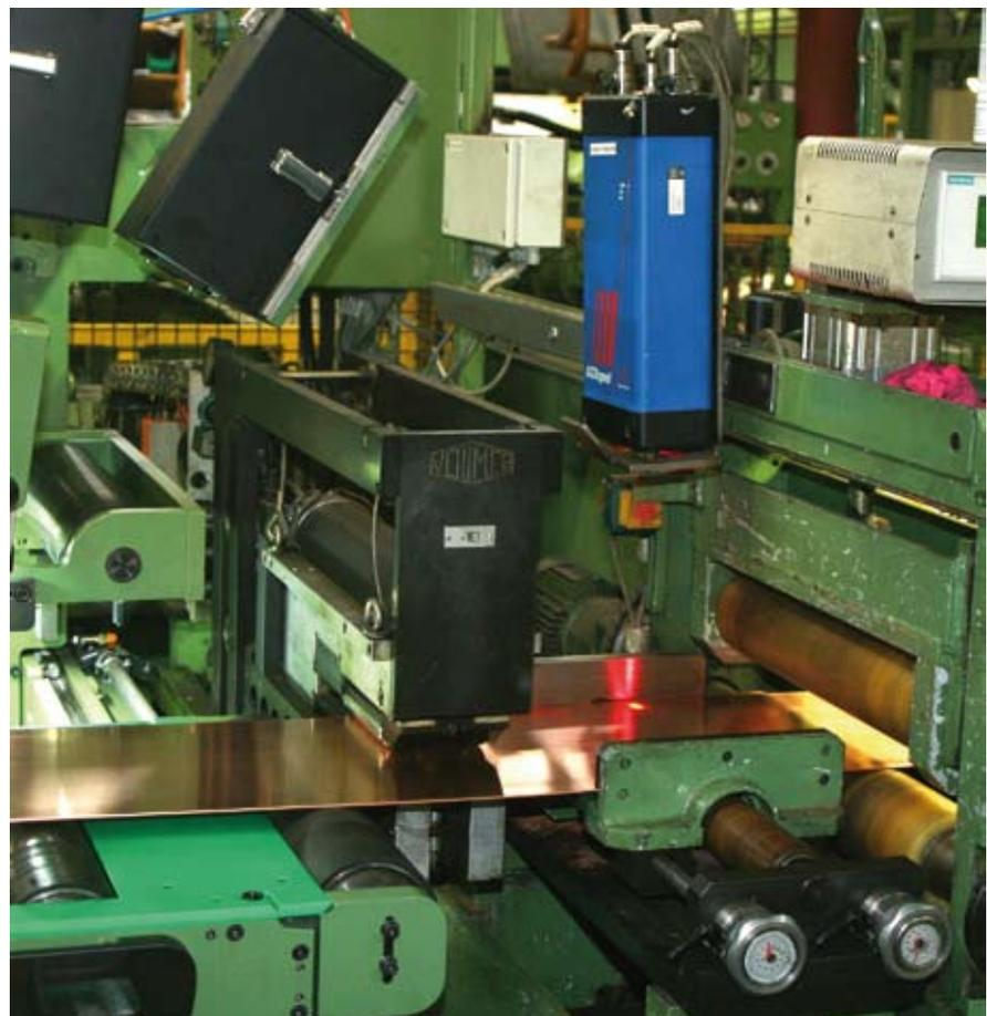
**Bild 5: Erfassung hochgenauer Bandlängen**
