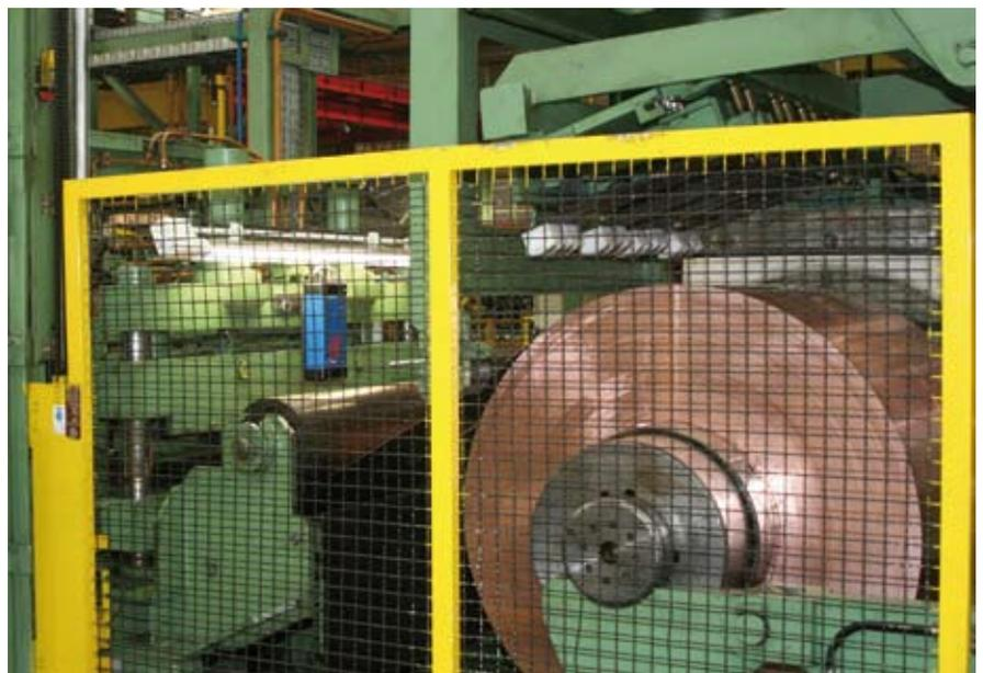
Bild 7: Geschwindigkeitsmessung für Bundrechner
